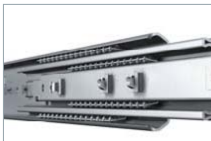
Schubladenführung, kugellagert, 100% ausziehbar, Schubladen mit 50 mm Blendenhöhe, 70 kg Tragkraft, Schubladen ab 75 mm Blendenhöhe 100 kg oder 180 kg Tragkraft
