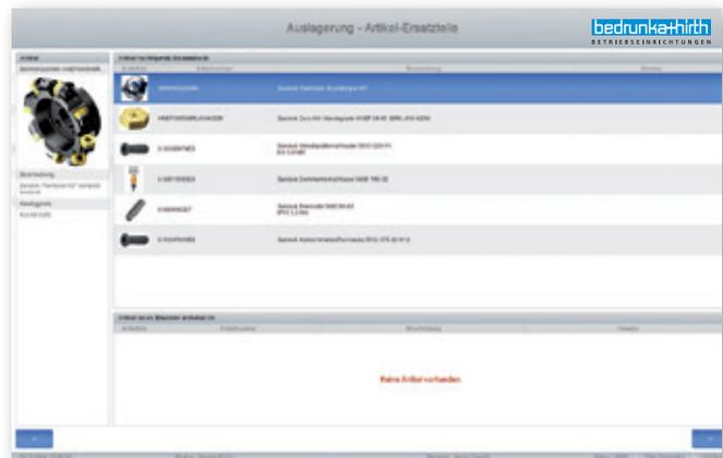
Eine integrierte Ersatzteilverwaltung erlaubt es, eingelagerte Komplettwerkzeuge in die benötigten Ersatzteile aufzulösen. Das erleichtert die Suche nach verschlissenen Werkzeugen, die ersetzt werden müssen. Diese werden über das Komplettwerkzeug angezeigt.
