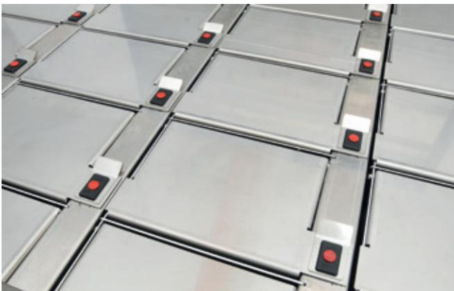
Sollte Sicherheit bei der Ausgabe eine zentrale Rolle spielen, so lassen sich alle Schubladen auch in "Hochsicherheitszellen" für Werkzeuge jeder Art einteilen. Hierbei werden Metallklappen eingesetzt, die nach dem gleichen Prinzip, wie bei den Schubladen elektromechanisch verriegelt werden. Unterschiedliche Klappengrößen sind lieferbar.
