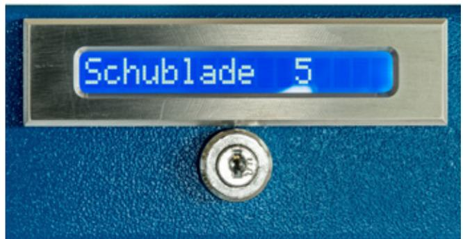
Die entriegelte Schublade und Klappe wird dem Benutzer am Touchscreen und zusätzlich am gut abzulesenden, mehrstelligen LCD-Display angezeigt. Die "Notentriegelung" des Moduls erfolgt über einen Schlüssel.
