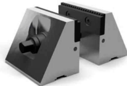
Werkstück wird zuerst mit der Zentrierspindel, dann mit der Spannschraube gespannt.
